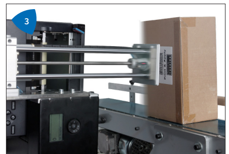
3 Veelzijdig, labels aanbrengen aan de bovenkant, onderkant of zijkant in elke rotatiehoek.
