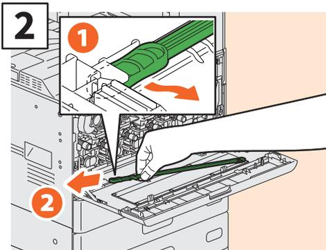
Retirez le dispositif de nettoyage de la fenêtre d'exposition à l'intérieur du capot.
