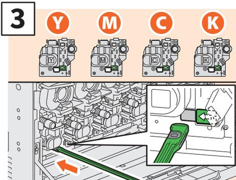
Insérez en entier le dispositif de nettoyage sous le développeur.
