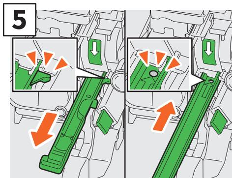
Retirez le dispositif de nettoyage jusqu'à ce que le développeur soit visible. Répétez cette opération 3 fois pour chacune des couleurs. Après avoir nettoyé la tête d'impression à DEL, retournez les 4 leviers verts et remettez le dispositif de nettoyage à l'intérieur du capot frontal.
