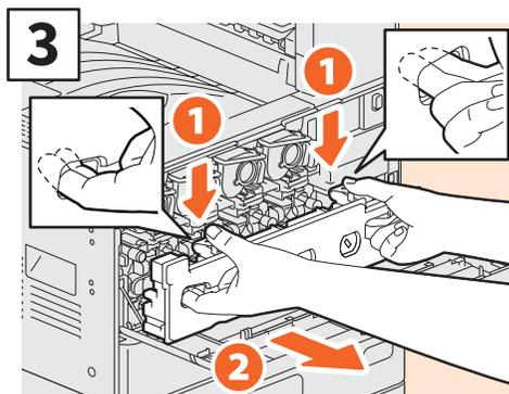
Placez vos doigts sur les rainures avant du bac récupérateur de toner usagé et tirez-vous en appuyant sur le loquet supérieur. Nettoyez ensuite les têtes d'impression à LED ou la fenêtre d'exposition.
