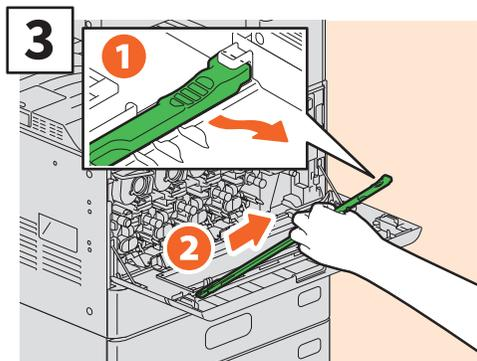
Retirez le dispositif de nettoyage de la tête d'impression à DEL à l'intérieur du capot.
