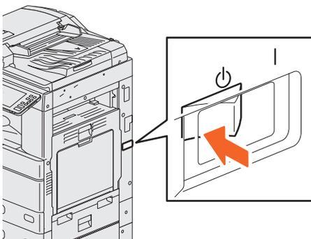
Sélectionnez [Arrêt (Shutdown)] pour sélectionner une option d'arrêt. Vérifiez que le bouton [ECO. ENERGIE (ENERGY SAVER)] (vert) cesse de clignoter et que l'écran tactile est éteint. Mettez le système hors tension à l'aide de l'interrupteur d'alimentation électrique principal.
