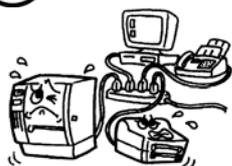
Si la machine partage une même prise avec d'autres appareils consommant beaucoup d'électricité, il y aura des fluctuations de tension importantes lorsque ces appareils fonctionnent. Pour éviter tout risque d'**incendie** ou de **choc électrique**, ne branchez pas d'autres appareils à la même prise que la machine.
