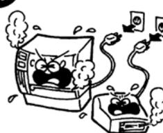
Une utilisation prolongée de l'imprimante dans une condition anormale, comme par exemple lorsque l'imprimante produit de la fumée ou des odeurs étranges peut être source d'**incendie** ou de choc électrique. Dans ce cas, éteignez immédiatement l'interrupteur marche/arrêt et déconnectez le câble secteur de la prise murale. Ensuite, contactez votre revendeur agréé TOSHIBA TEC pour une assistance technique.
