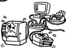
Si la machine partage une même prise avec d'autres appareils consommant beaucoup d'électricité, il y aura des fluctuations de tension importantes lorsque ces appareils fonctionnent. Pour éviter tout risque d'**incendie** ou de **choc électrique**, ne branchez pas d'autres appareils à la même prise que la machine.
