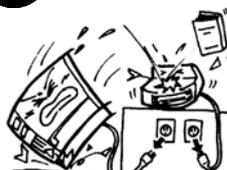
Si les machines tombent, ou que leur capot est endommagé, commencez par positionner le bouton marche/arrêt sur arrêt et par déconnecter le câble secteur de la prise murale. Ensuite, contactez votre revendeur agréé TOSHIBA TEC pour une assistance technique. Une utilisation prolongée de l'imprimante dans ces conditions peut être source d'**incendie** ou de choc électrique.
