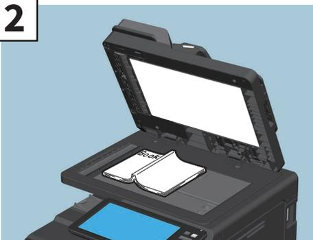
Placez l'original face vers le bas sur la vitre d'exposition et alignez-le dans l'angle supérieur gauche de la vitre.
