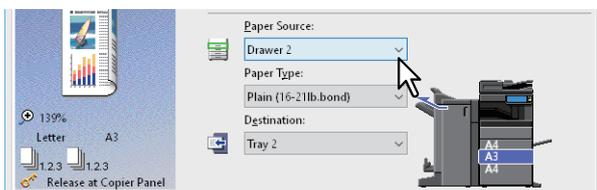
La couleur de la source de papier sélectionnée change dans la zone d'aperçu dans l'onglet [Principal (Basic)].
