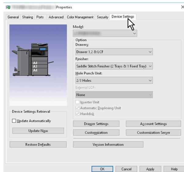
**Modèle :** définit le type de modèle. Les paramètres de configuration changent en fonction du modèle sélectionné.
